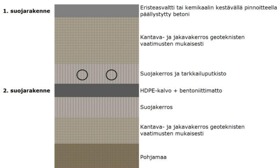
Kuva 5. Periaatekuva suoja-altaiden rakenteesta
